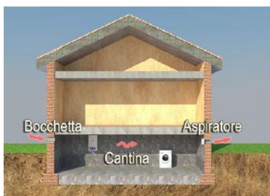
Schema dell'intervento di ventilazione forzata delle cantine.
