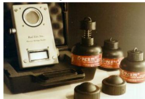
dosimetro ad elettrete con disco di teflon
