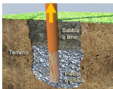
Esempio di realizzazione dello scavo esterno per l'estrazione del radon dal suolo.
