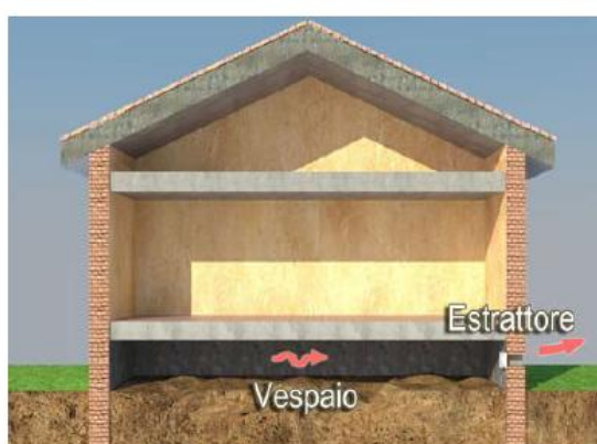
Schema dell'intervento di ventilazione forzata del vespaio.
