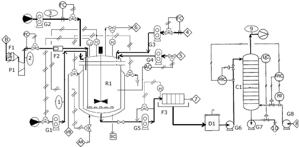
SCHEMA DI PROCESSO DI BIOFERMENTAZIONE AEROBICA E RECUPERO METABOLITA CON ESTRAZIONE LIQ-LIQ IMMISCIBILI
