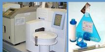
CAMPIONAMENTO dell'ARIA col RADIELLO
