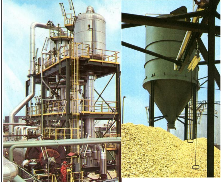
c) FORNO CLAU (marrone in basso a sin.) e caldaie recupero en. (in alto) – SERBATOIO RACCOLTA ZOLFO (a destra)
