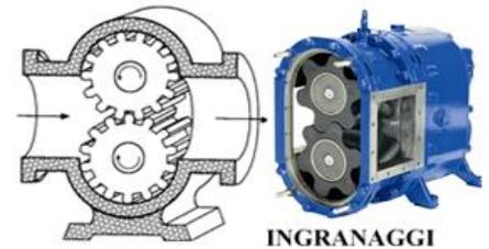
● **POMPA A LOBI:** è una modifica di quella ad ingranaggi, in cui gli ingranaggi sono sostituiti da lobi [con meno denti]. Quindi la portata erogata non è continua, ma leggermente pulsata. Il livello di pulsazione diminuisce all'aumentare del numero dei denti. Può trasportare liquidi viscosi.
