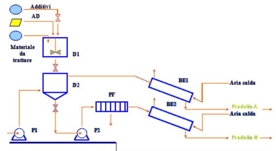
**3** - Lo schema di **PROCESSO** - PDF process flow diagram – ha lo scopo di far comprendere le caratteristiche di un processo industriale. Tale schema contiene:
