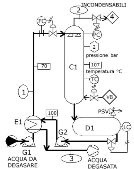
**4** - Lo schema di **MARCIA** - P&ID piping and instrumentation diagram - rappresenta lo schema di impianto completo.
