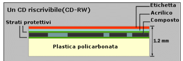
Sezione di un CD riscrivibile
